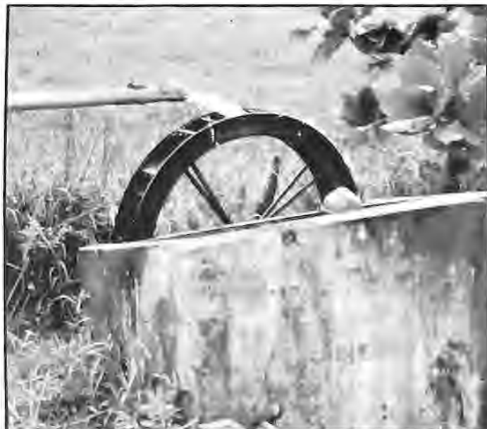
Uma pequena bomba hidráulica é utilizada na obtenção da água.
